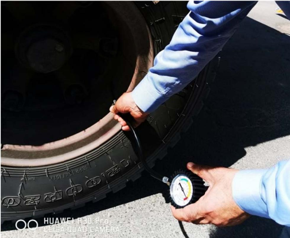
الشكل 2: جهاز قياس ضغط الإطار
